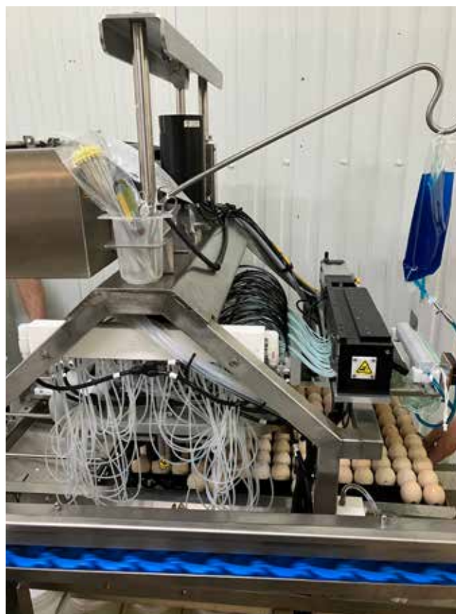
Bij in ovo vaccinatie wordt het vaccin in de broerij op dag 18 van het broedproces geïnjecteerd in de ruimte (amnion) rondom het kuikenembryo. Foto copyright PeheVaxx®.
